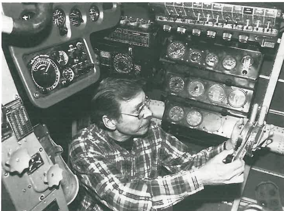
Framkroppen i museets B 18B håller på att inredas. ÖFS projektledare Ken Wallin provar läget för oljekylaren
